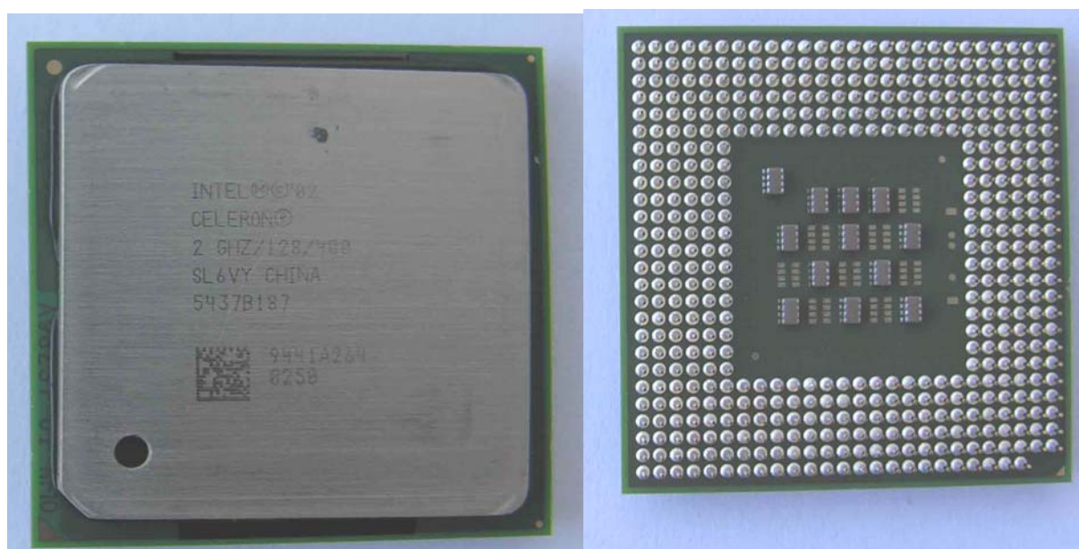
Rys. 4 Widok procesora Celeron®, przystosowanego do instalacji w gnieździe typu Socket 478
