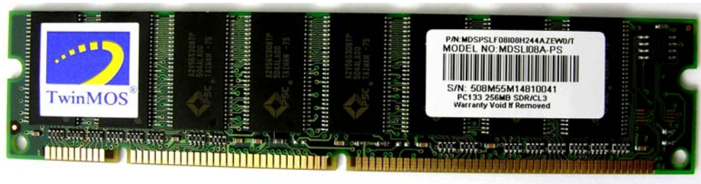
Rys. 7 Pamięć DIMM typu SDRAM
