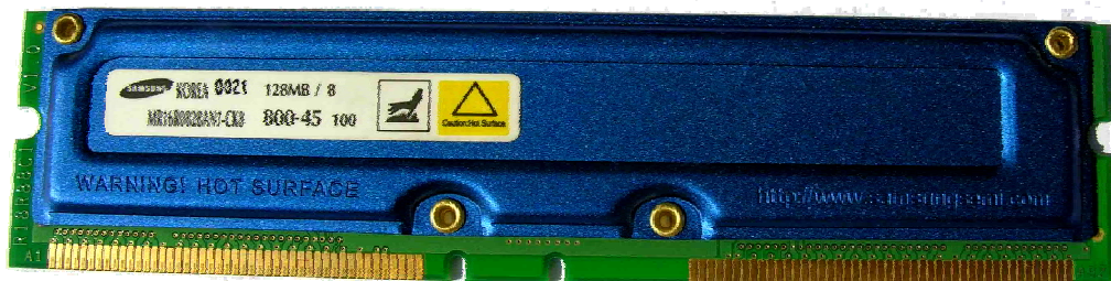
Rys. 9 Pamięć DIMM typu RDRAM
