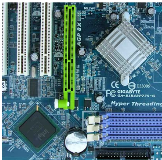
Rys. 15 Chipset płyty głównej Intel 848 P
