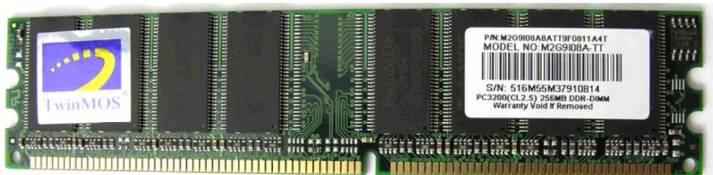
Rys. 8 Pamięć DIMM typu DDRAM
