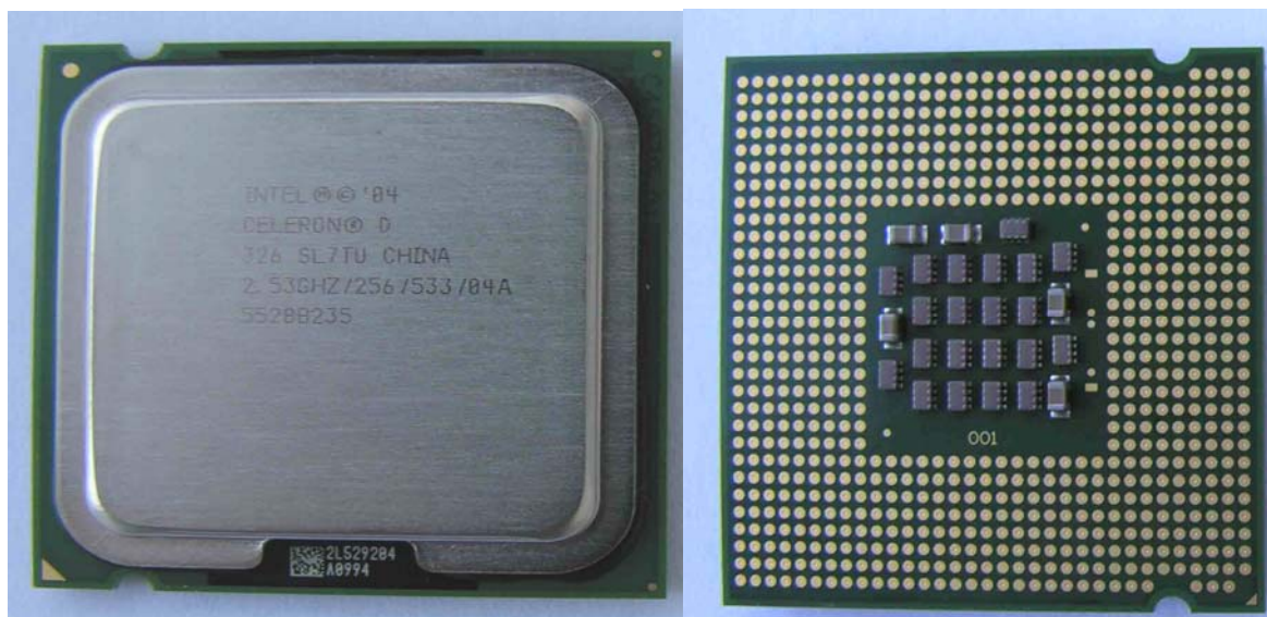
Rys. 3 Widok procesora Celeron®, przystosowanego do instalacji w gnieździe typu Socket 775
